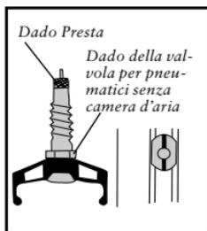
Figura 3.88- Stelo della valvola per pneumatici senza camera d'aria
