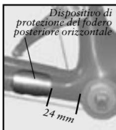
Figura 3.105- Dispositivo di protezione del foderi posteriore orizzontale
