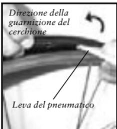
Figura 3.95- Arrotondamento della guarnizione del cerchione
