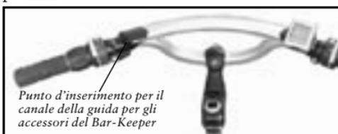
Figura 3.8 - Vista del ciclista del Bar-Keeper
