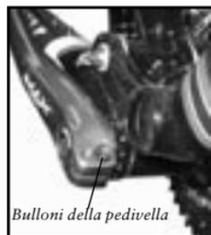
Figura 3.17 - Bulloni della pedivella di tipo a serraggio controllato
