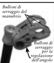
Figura 3.4 - Stelo tubolare regolabile in altezza
