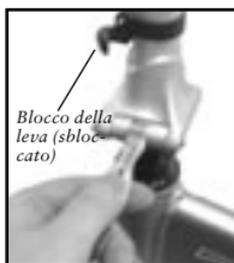
Figura 3.110- Apertura del dispositivo di sgancio rapido inferiore
