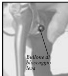
Figure 3.46- Bullone di bloccaggio leva
