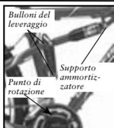
Figura 3.102- Componenti della sospensione Sugar
