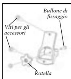
Figura 3.9 - Schema di montaggio dell'attacco Bar-Tab
