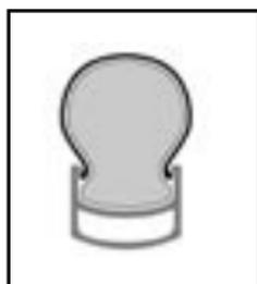
Figura 3.86- Camera d'aria inserita tra il pneumatico e il cerchio
