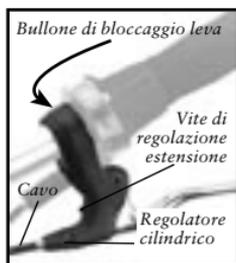
Figure 3.48- Leva del freno
