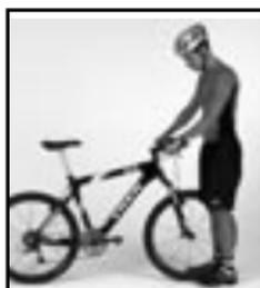
Figura 3.5 - Controllo di funzionamento del manubrio e dello stelo
