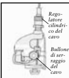
Figura 3.35 - Bullone di serraggio del cavo della leva a squadra
