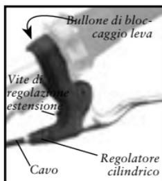
Figura 3.61- Leva del freno
