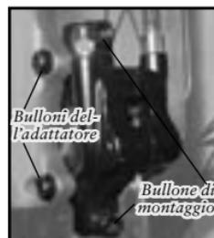
Figura 3.56- Bulloni di fissaggio del freno a disco
