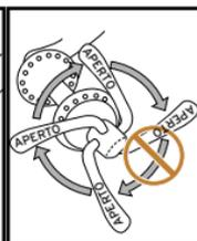
Figura 3.68- Non ruotare la leva
