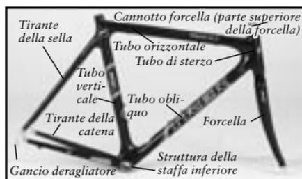
Figura 1.1-Nomi di parti del telaio
