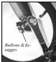
Figura 3.76- Bulloni di fissaggio della ruota anteriore del triciclo
