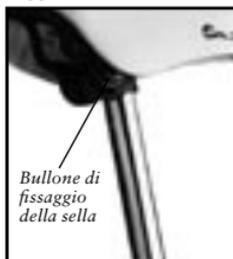
Figura 3.11 - Bullone di fissaggio della sella con chiave da 13 o 14 mm
